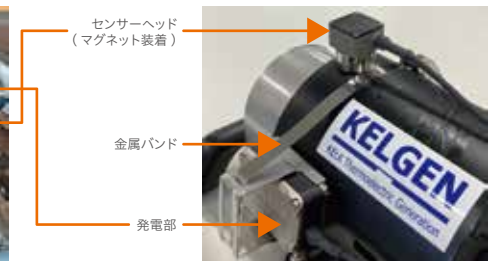
金属バンドによる発電部の設置例
